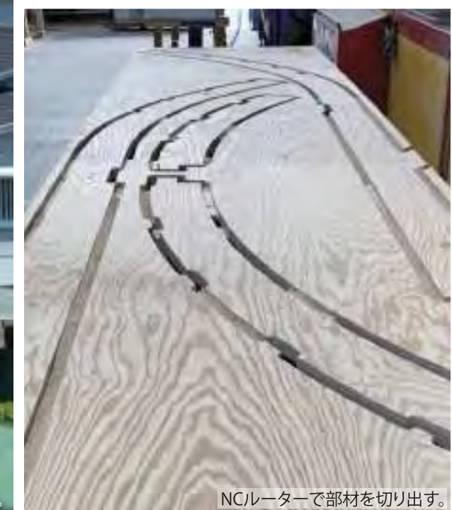
CNCレーザーで部材を切り出す。
